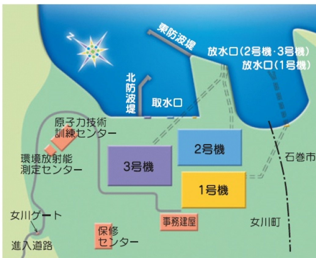
図 3.1 発電所の全体配置（震災当時）
