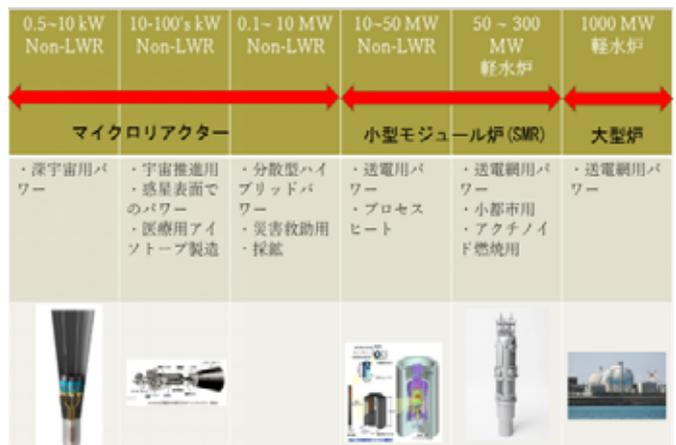
図1 炉の出力と冷却材及び用途のまとめ（INELの分類図を基に作成）
