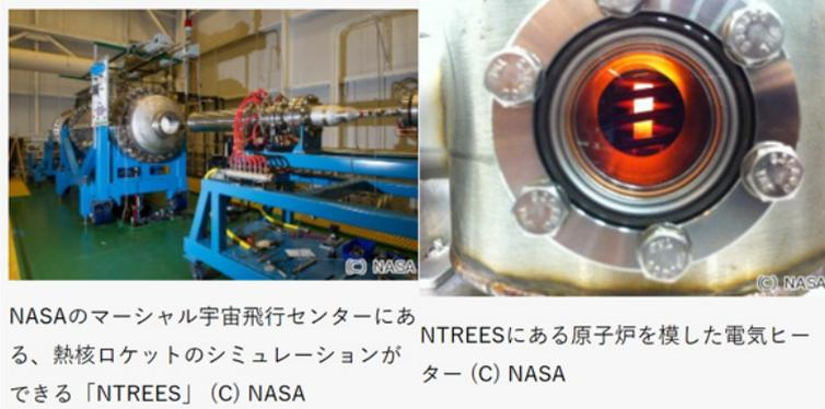
NASAのマーシャル宇宙飛行センターにある、熱核ロケットのシミュレーションができる「NTREES」 (C) NASA
